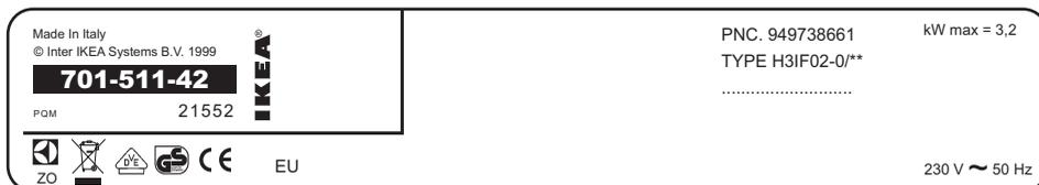
La figure ci-dessus illustre la plaque signalétique de l'appareil (sans le numéro de série qui est créé dynamiquement pendant le processus de production), située sous le boîtier de la table de cuisson.
